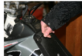
RETIRER LES VIS DE FIXATION SUPERIEURES DES FLANS DROIT ET GAUCHE SUR LE RÉSERVOIR.
