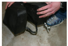
RETIRER LE RÉSERVOIR EN PRENANT SOIN DE BOUCHER LA MISE EN PARALLELE DES 2 COTÉS DU RÉSERVOIR.
